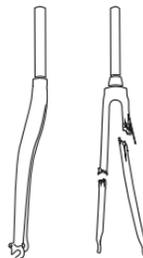
Рисунок 2.5. Слева: металлическая вилка, изогнувшаяся от чрезмерной нагрузки. Справа: углеволокновая вилка, выдержавшая более высокую нагрузку, но полностью разломившаяся после перегрузки.
