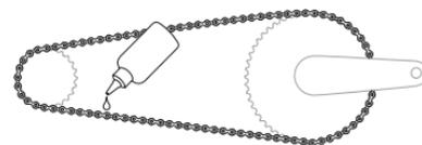
Рисунок 2.3. Нанесение смазки на нижний участок цепи.
